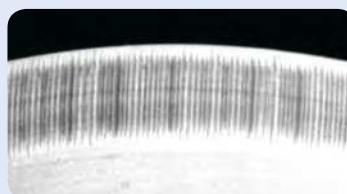
Marcas de estrias características da erosão elétrica em rolamentos
