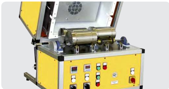
Teste de estabilidade ao rolo
