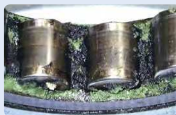
Degradação do lubrificante causada por descargas elétricas
