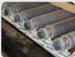
Superaquecimento de rolamento de esteira rolante
